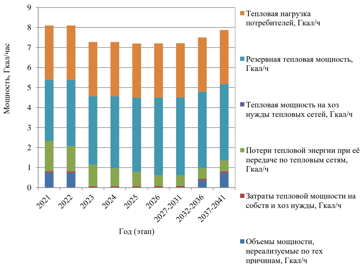
Рисунок 1.5 – Перспективные балансы тепловой мощности источников тепловой энергии и тепловой нагрузки потребителей котельной п. Красный Яр
